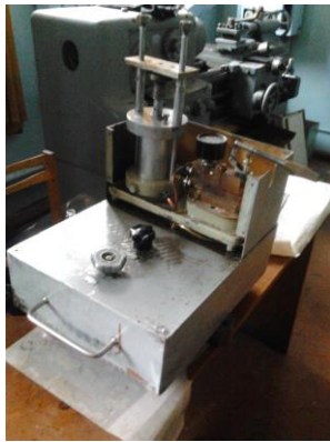
Рис. 3. Экспериментальная модель: а - стенд ударный; б - устройство ударного нагружения стенда ударного: 1-гидроцилиндр; 2-верхняя поперечина; 3-седло специальное; 4, 6, 7-уплотнения; 5-нижняя поперечина; 8-кольцевое уплотнение; 9-шток-клапан
