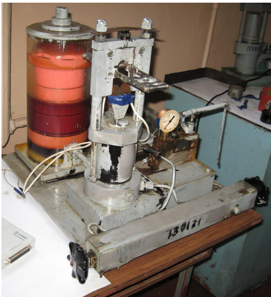
Рисунок 3.4 – Экспериментальная установка стенда ударного
