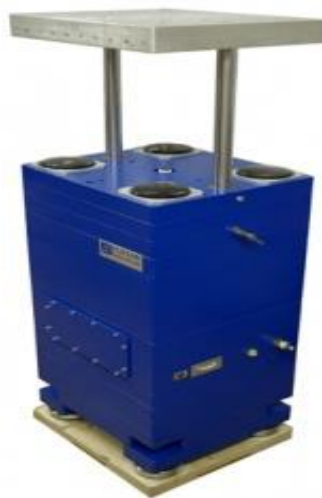
Рисунок А.5 – Ударный стенд STM50
